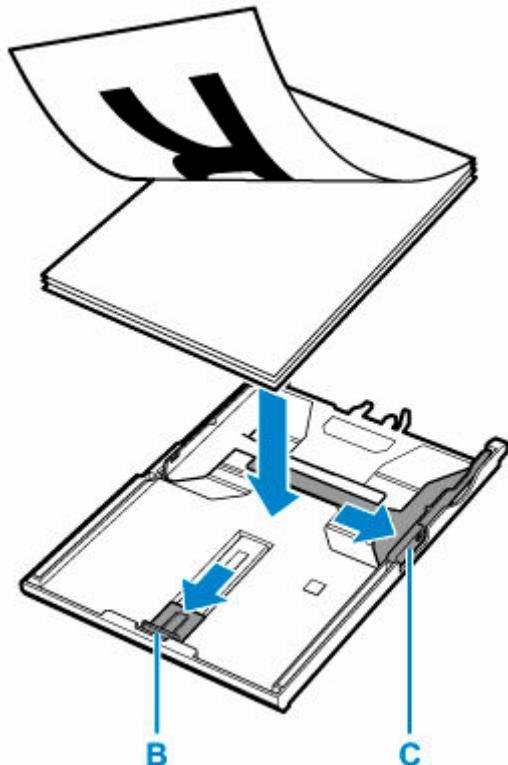
4. Alignez les guides papier (B) à l'avant et (C) à l'arrière avec la longueur et la largeur du papier.
