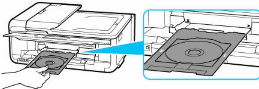
**16.** Insérez le tiroir multifonctions directement à l'horizontale jusqu'à ce que la flèche (▼) du guide tiroir multifonctions soit à peu près alignée avec la flèche (▲) située sur le tiroir multifonctions.
