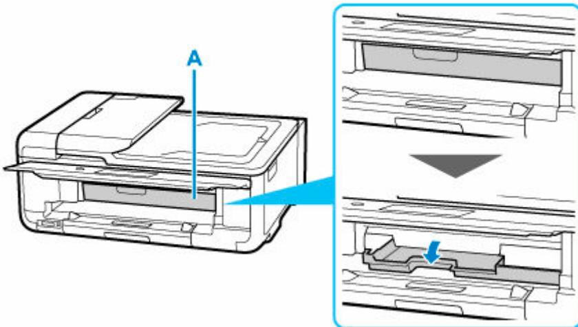
**3.** Positionnez les Autocollants pour ongles imprimables dans le tiroir multifonctions.
