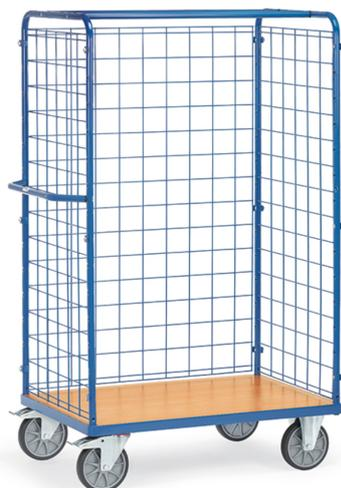
Ensemble mécano-soudé, revêtement époxy bleu RAL 5007. 1 plateau fixe en mélaminé surface effet hêtre. 3 côtés grillagés maille de 100 x 100 x 5 mm. 2 roues pivotantes et 2 roues fixes à bandage TPE, moyeu à roulement à billes central. Freins sur roues pivotantes.
