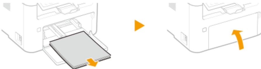
**5 Fermez le capot avant, la butée du papier et les parties similaires, puis déplacez l'appareil jusqu'à sa nouvelle destination.**
