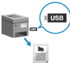
Avec l'impression sur support mémoire, vous pouvez imprimer des fichiers PDF, JPEG et TIFF directement à partir d'un périphérique USB inséré dans l'appareil sans utiliser d'ordinateur ou de pilote d'imprimante. Vous pouvez également prévisualiser les fichiers image JPEG et TIFF sur le panneau de commande avant l'impression. Cette fonction est pratique lorsque vous imprimez des fichiers sur un ordinateur sans connexion réseau ou à partir d'un périphérique externe.
