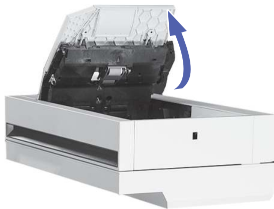
Figure 9-11 Ouverture de la porte d'accès au bourrage du bac d'alimentation
