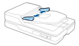
2. Chargez l'original droit dans le bac d'insertion face vers le haut, en plaçant le bord d'attaque dans l'ADF. Glissez l'original dans l'ADF jusqu'à ce que vous sentiez une résistance.
