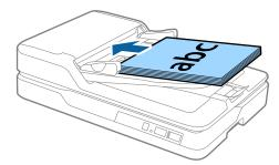
4. Faites coulisser les guides latéraux pour les adapter à la largeur des originaux, en vous assurant qu'il n'y a pas d'espace entre les originaux et les guides latéraux. Autrement, les originaux pourraient être insérés de travers.
