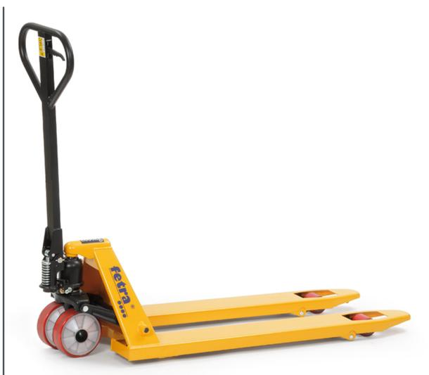
Châssis et fourches en tôle d'acier, revêtement époxy jaune. Pompe hydraulique manuelle sans entretien. Poignée en caoutchouc pour: lever - rouler - descendre. Rotation: 2 x 100°. Galets en tête de fourches. Résistance au roulement modérée, non traçantes.
