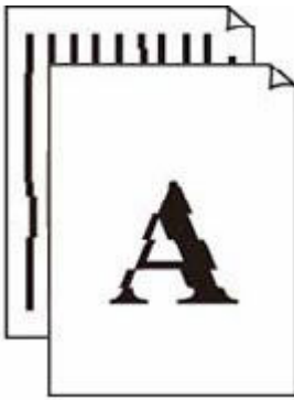
Les lignes sont mal alignées/déformées
